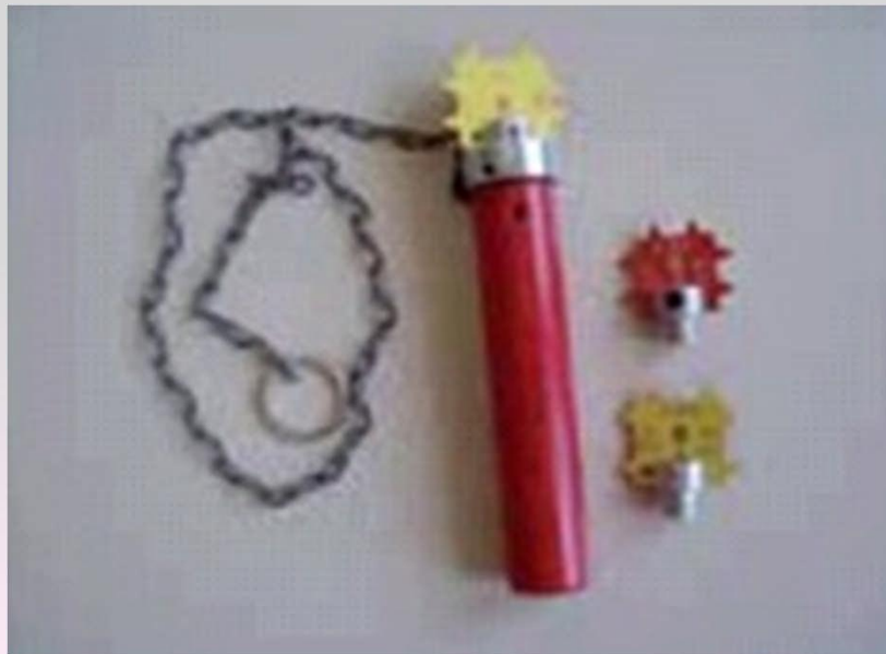
Figure 7 : Relascope à chaînette suédois et relascope « porc-epic » : ces appareils possèdent 4 encoches correspondant à des facteurs K = 1/2, 1, 2, \text{ ou } 4 ( catalogue ZIMMER , 2004).
