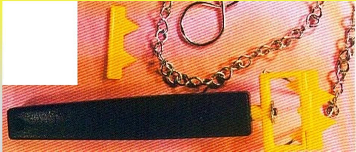
Figure 7 : Relascope à chaînette suédois et relascope « porc-epic » : ces appareils possèdent 4 encoches correspondant à des facteurs K = 1/2, 1, 2, \text{ ou } 4 ( catalogue ZIMMER , 2004).
