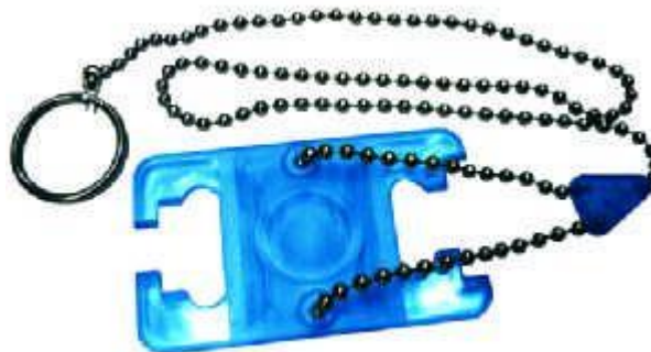
Figure 5 : Relascope à chaînette (valeur : environ 25 €)
