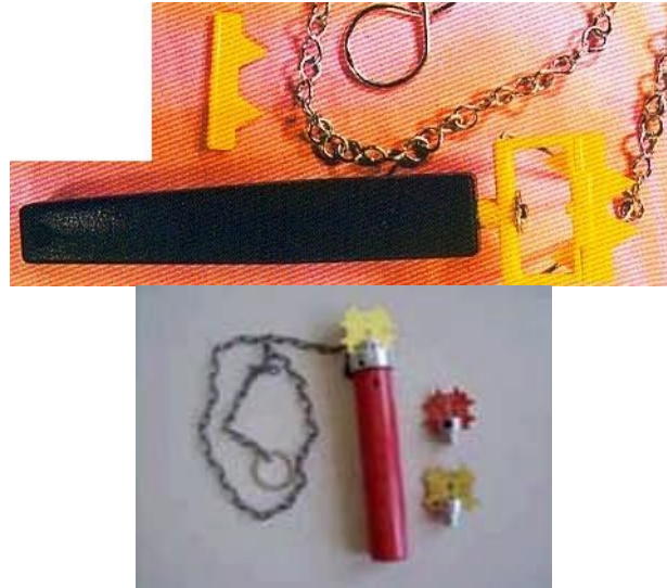
Figure 7 : Relascope à chaînette suédois et relascope « porc-épic » : ces appareils possèdent 4 encoches correspondant à des facteurs K = 1/2, 1, 2, \text{ ou } 4 ( catalogue ZIMMER , 2004).
