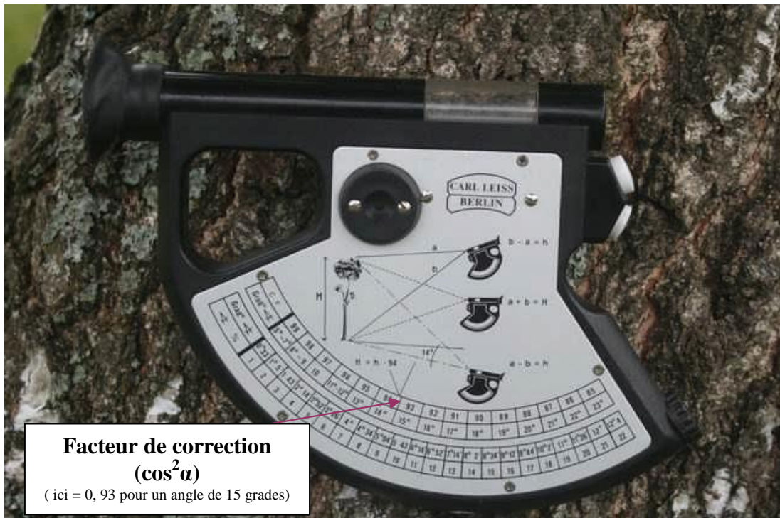
Figure 7 : Correction due à la pente : échelle de valeurs du facteur de correction sur le Blum Leiss.
