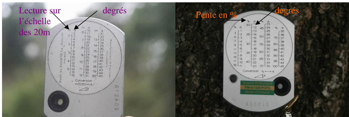
Figure 9 : Dendromètre Suunto : échelles de conversion donnant la pente en grades ou en degrés
