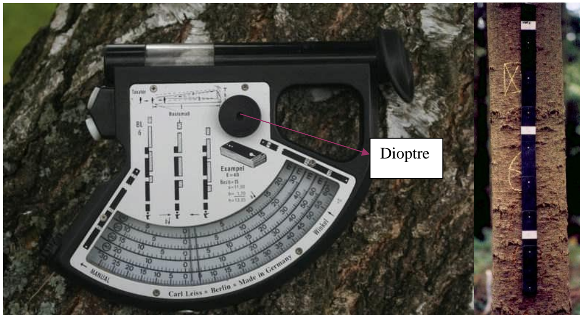
Figure 5 : Dendromètre Blume-Leiss et mire
